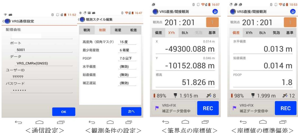
図－7 位置情報サービス事業者とのデータの送受信に使用される端末装置の操作画面の例
