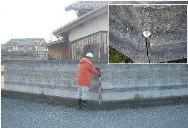
写真-9 構造物側面などの筆界点
